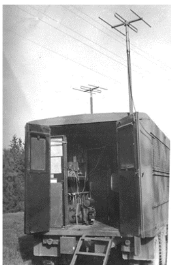
Verkstads vagn med installerad radiolänkmateriel som ändstation
